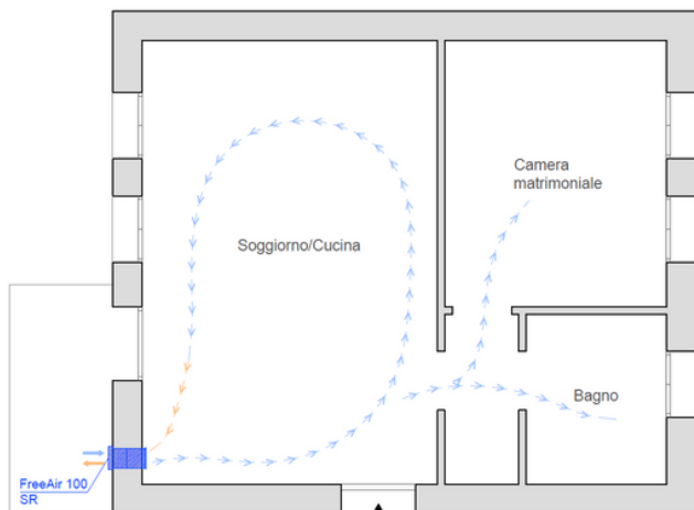
Esempio di un'unità freeAir100e SR installata nel soggiorno
