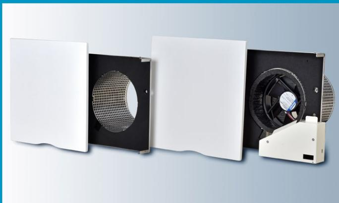
Unità di trasferimento interna freeAirPlus che serve a modulare l'aria nella camera da letto quando è necessario. E' dotata di sensore di temperatura, umidità e VOC-COV (composti organici volatili). Viene installata sopra la porta interna o a lato.
