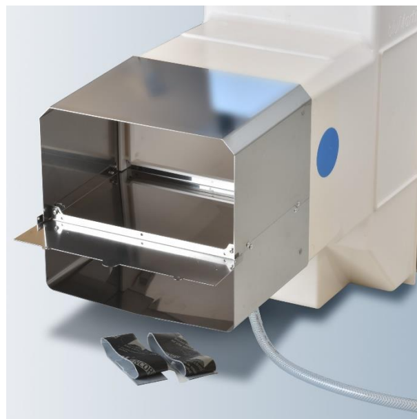
Se spessore muro è maggiore di 53 cm, utilizzare prolunga da 16 cm/cad, cod. art. FA00.2003. Da utilizzare anche in caso di installazione a semi-incasso.
